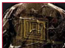
3 tepelné zóny šité z uhlíkových vláken na hrudi vpravo a vlevo, na zádech
